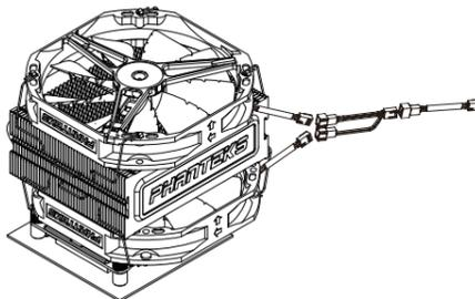
팬의 전원 케이블 두 개를 팬 스피리터에 연결합니다. 팬 스피리터를 마더보드 CPU 팬 헤더에 연결합니다. 또한 Phanteks PH-F140 PWM 팬 외장 어댑터를 팬 스피리터에 끼우고 마더보드에 연결할 수 있습니다. 외장 PWM 어댑터는 PH-F140 팬이 700-1200 rpm에서 저소음으로 동작하게 할 수 있습니다.
