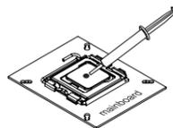
써멀 페이스트 또는 써멀 패드의 찌꺼기가 CPU에 남아 있을 경우, 우선 깨끗이 닦아내십시오. 그런 다음 Phanteks PH-NDC를 직경 4-5mm 정도 방울 크기 만큼 CPU 표면 중앙에 퍼서 바릅니다.
