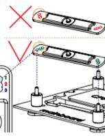
**주의:** 스트립 어댑터의 소켓 구멍이 후면판 소켓 구멍과 정렬되어 있는지 확인하여 스트립 어댑터의 잘못된 설치를 방지하십시오. 스트립 어댑터 두 개를 스티드에 장착합니다. **주의:** INTEL 장착 스트립 어댑터를 원하는 쿨러 최종 방향에 맞게 정렬하십시오.
