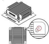
Verschrauben Sie den Kühlkörper mit der CPU. (Ziehen Sie die Schrauben nicht übermäßig an; ziehen Sie nicht weiter an, wenn Sie einen Widerstand spüren.)
