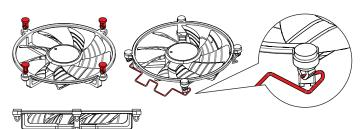
Setzen Sie die Lüfterclipadapter (4 Stück) in die entsprechenden Öffnungen. (siehe Abbildung)
