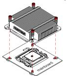
Setzen Sie den Kühlkörper auf die CPU auf. Achten Sie darauf, dass die Öffnungen übereinander liegen.
